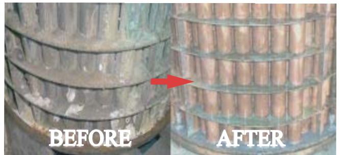
内径800mm、全長5mの熱交換器 処理時間は、最大で5時間以内(従来製品では8時間-12時間以上)
