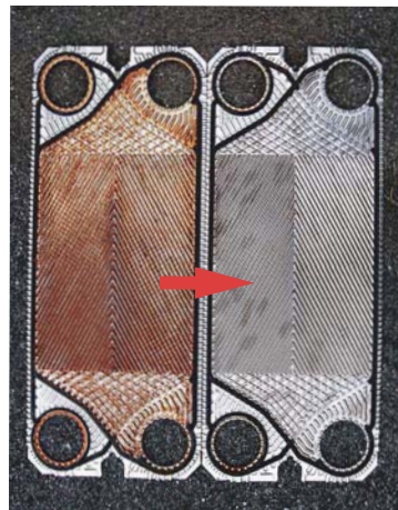
プレート式熱交換器洗浄結果
