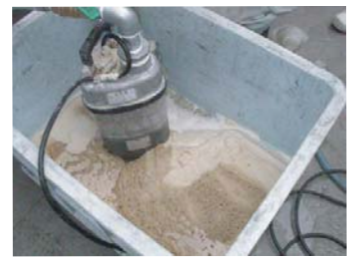
ダイナミックデスクリーンの泡で、有機物 や固形物も発泡によって吹き飛ばされ 排出される。
