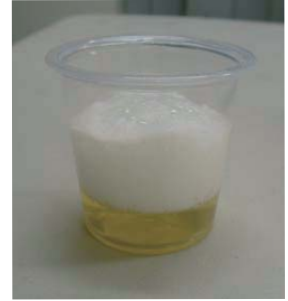
ダイナミックデスクリーンを投入すると 激しい発泡が起こる
